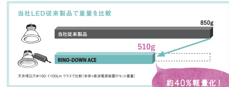
アルミダイキャスト一体成型により、反射板とフチを軽量化。
