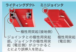
ミニジョインタには、ダクト本体同士の極性を合わせる逆組み防止の突起を付けることにより、誤配線や短絡を未然に防ぎます。
