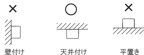
ライティングダクトの取付方向
